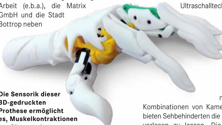
**Die Sensorik dieser 3D-gedruckten Prothese ermöglicht es, Muskelkontraktionen am Oberarm in Bewegung der Finger umzusetzen.**
